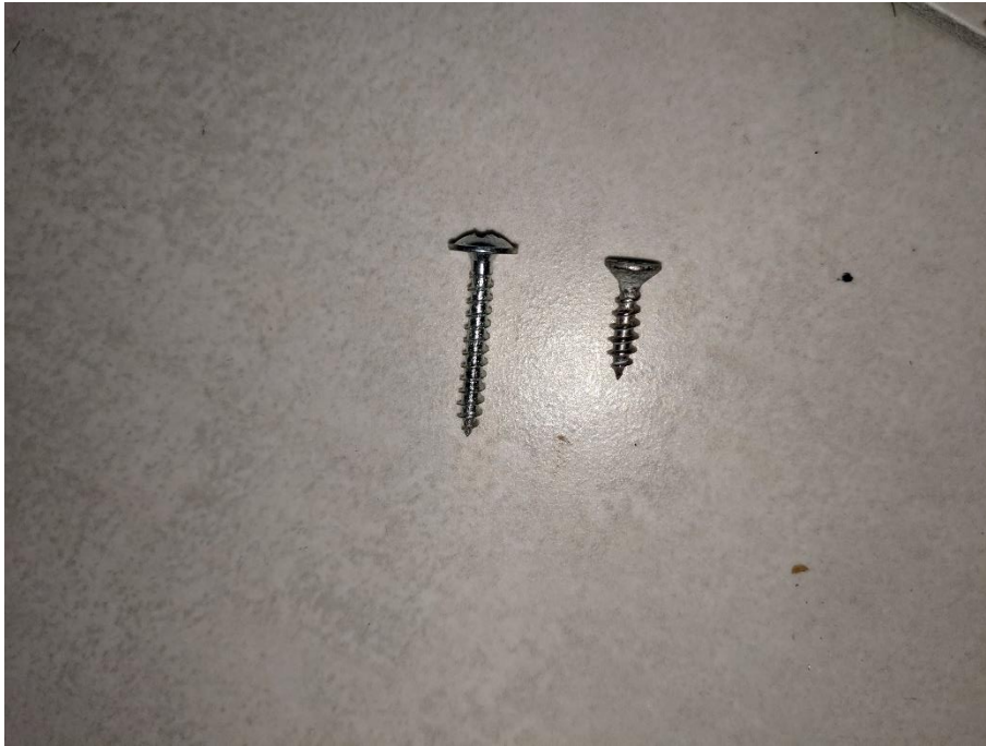
Ilustración 20: Tornillo de origen (derecha) y tornillo de sustitución inadaptado (izquierda)
