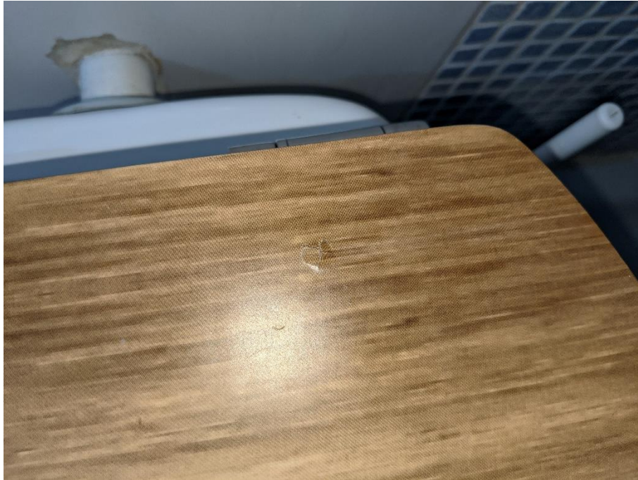
Ilustración 18: Tapa perforada y tornillo saliendo por el otro lado
