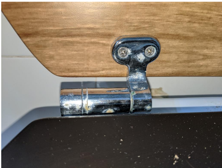
Ilustración 19: Bisagra izquierda de la tapa, donde una parte del mecanismo está desnudo
