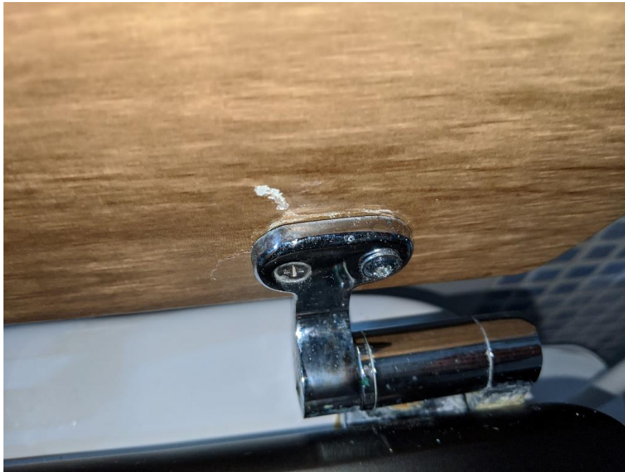
Ilustración 17: Bisagra derecha de la tapa, con tornillo que no es de origen y es inadecuado
